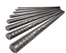
Produzido rigorosamente de acordo com as especificações da norma NBR 7480, o Vergalhão é fornecido na categoria CA-50 com superfície nervurada, garantindo assim maior aderência da estrutura ao concreto.
