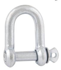
Medida da manilha: 3/8" - 9,53 mm Carga de trabalho da manilha: 0,30 t Material da manilha: Aço baixo carbono Abertura entre olhais da manilha (A): 20,0 mm Diâmetro do corpo da manilha (C): 9,1 mm Diâmetro do pino da manilha (D): 9,1 mm Largura externa da manilha (E): 37,0 mm
