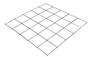
Malha pronta para uso, produzida com aço CA-60 Nervurado e soldada em todos os pontos de cruzamento, garantindo maior segurança e evitando trincas, fissuras e embarrigamentos. Fornecimento no tamanho 2 m x 3 m.
