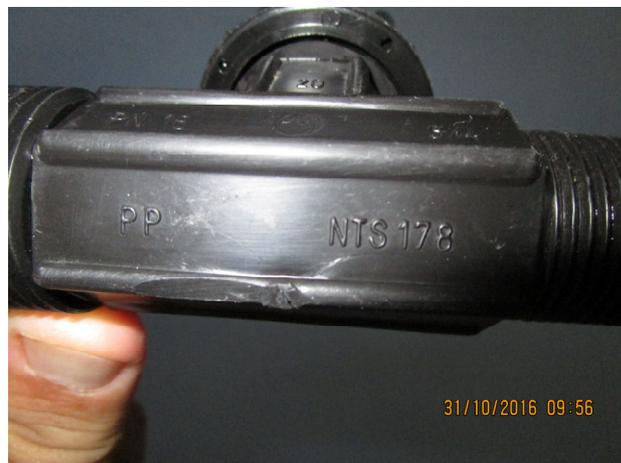
Figura 6: Exemplo de gravação da Norma na peça
