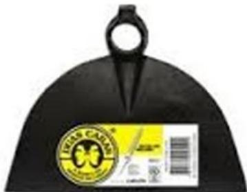
Enxada larga forjada em aço carbono especial sem cabo, lâmina com tamanho 2.0 peso 0,60kg medindo comprimento 191mm largura 274mm altura 42mm olho 38mm de diâmetro.
