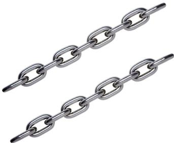
Diâmetro do elo da corrente (D): 12,5 mm. Acabamento da corrente: Zincada branca. Carga de trabalho da corrente: 1500 kgf
