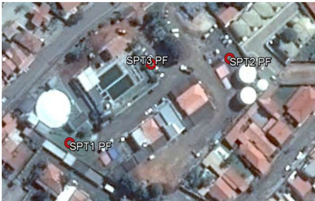
Figura 7.1. Locais onde foram executadas as sondagens a percussão.
